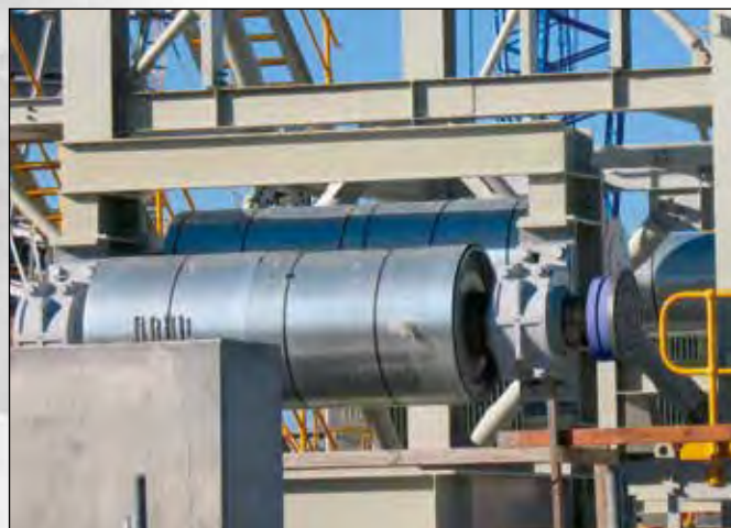
Bandtrommel mit Spannsätzen und einer Schrumpfscheibe auf der Antriebsseite Conveyor pulley with Locking Assemblies and a Shrink Disc on the drive side
